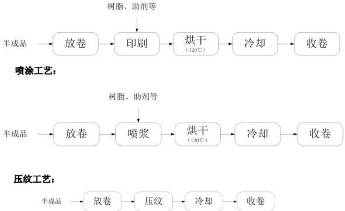
图 4-8 后段处理工艺流程
