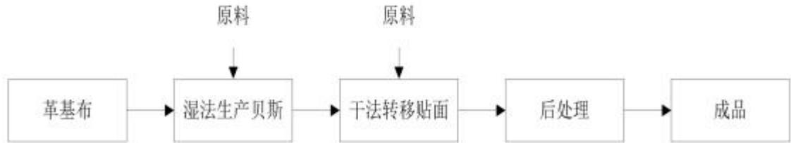
图 4-5 生产总工艺流程
